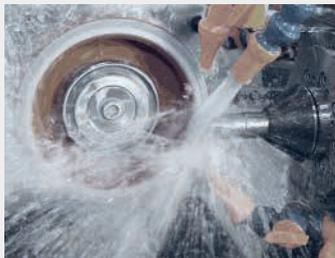
CHALLENGE-Schleifflüssigkeiten verbessern die Qualität und Konsistenz des Schliffs und verlängern gleichzeitig die Lebensdauer der Diamantscheiben.
