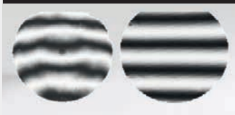
In Paralleltests mit denselben Anlagen und Prozessparametern übertrifft IC OPTIC die MH-Petal-Tücher sowohl in der Oberflächen-güte als auch in der Form. Die Oberflächenrauheit wurde um bis zu 25% verbessert.
