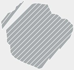
Partikelstruktur monokristalliner Diamant
